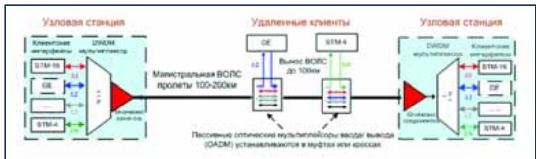
Рис. 6. Схема сети с использованием DWDM пунктов доступа.
